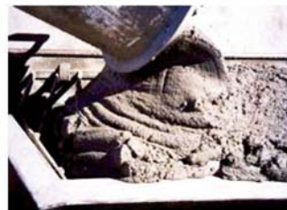
乳状水泥流 / 颗粒急剧减少 65 毫米
